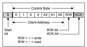
**FIGURE 3-4:** I<sup>2</sup>C Control Byte Format.
